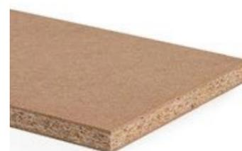
PremiumBoard MFP Hybrid è costituito da un'anima centrale in PremiumBoard MFP e copertine HDF dello spessore di 2 mm nobilitabili anche su entrambi i lati. L'incollaggio tra MFP e HDF avviene con colla PVAC (D4). Grazie alla resistenza alla flessione isotropa, all'elevata resistenza all'estrazione delle viti e alla buona stabilità dimensionale, questo pannello ibrido è ideale soprattutto per le applicazioni dove è richiesta stabilità e resistenza.
