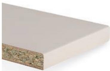
Pannello bilaminato con supporto in P3 a basso rigonfiamento come da EN 312, rivestito con Duopal HPL secondo la norma EN 438. Il bordo longitudinale postforming ha un raggio di 3 mm sia sulla parte superiore che inferiore, rendendo questo elemento, universalmente applicabile per la realizzazione di mobili, davanzali per finestre o piani da lavoro sottili.
