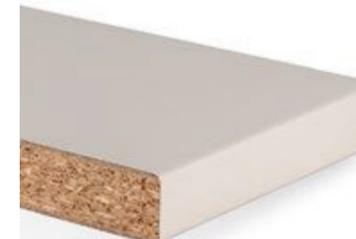
Piano da lavoro composto da un pannello truciolare come da norma EN 312, rivestito un lato con Duopal HPL come da norma EN 438. Il lato inferiore è costituito da una controbilanciatura idrorepellente. Il bordo anteriore postforming del piano di lavoro Quadra ha un raggio di 3 mm, mentre quello posteriore è sigillato con un bordo protettivo. Disponibile anche nella variante postforming due lati.
