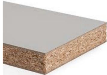
Piano da lavoro composto da un pannello truciolare come da norma EN 312, rivestito un lato con Duropal HPL come da norma EN 438. Il lato inferiore è costituito da una controbilanciatura idrorepellente. I bordi longitudinali sono fresati.
