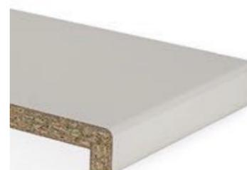
Davanzale per finestre composto da un pannello truciolare a basso rigonfiamento come da norma EN 312, rivestito con HPL Duopal come da norma EN 438. Il lato postforming ha un raggio di 3 mm ed è provvisto di una piegatura. La piegatura di 38 mm conferisce a questo davanzale una particolare nota estetica e consente di coprire elegantemente eventuali sporgenze o di applicare il rivestimento ai caloriferi.
