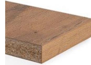
Piano da lavoro composto da un pannello truciolare come da norma EN 312, rivestito un lato con Duropol HPL come da norma EN 438. Il lato inferiore è costituito da una controbilanciatura idrorepellente. Un lato del piano da lavoro PerForm è dotato di bordo applicato con tecnologia laser, mentre l'altro è sigillato con un bordo protettivo. È disponibile anche nella versione con bordo laser su entrambi i lati.
