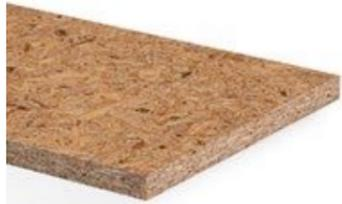
Pannello a base di legno tipo P7 secondo la norma EN 312, altamente resistente, per strutture portanti in aree umide, non rivestito e incollato al 100% senza formaldeide.
