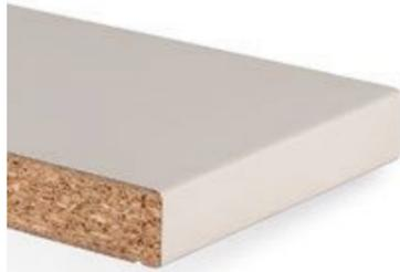
Piano da lavoro composto da un pannello truciolare come da norma EN 312, rivestito un lato con Duropol HPL come da norma EN 438. Il lato inferiore è costituito da una controbilanciatura idrorepellente. Il bordo anteriore postforming del piano di lavoro Cubix ha un raggio di 2 mm, mentre quello posteriore è sigillato con un bordo protettivo. Disponibile anche nella variante postforming due lati.
